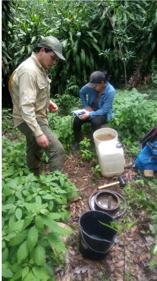
Figura 18: Prueba de infiltración por el método del doble anillo y muestreo de suelos realizados en las cercanías del Manantial Bajo Barrantes.
