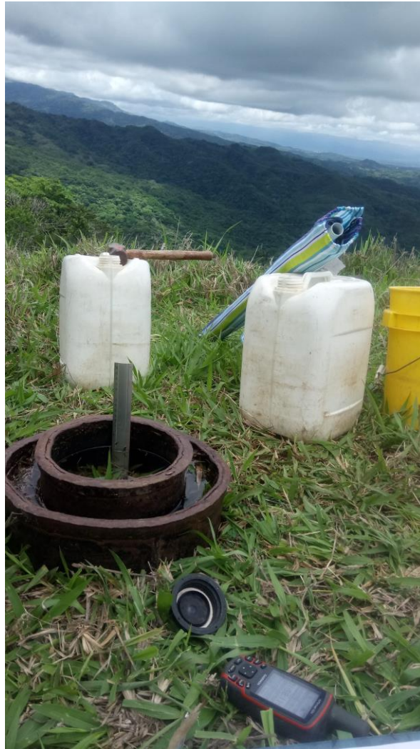
Figura 11: Prueba de infiltración por el método del doble anillo y muestreo de suelos realizados en las cercanías del Manantial El Salvador.
