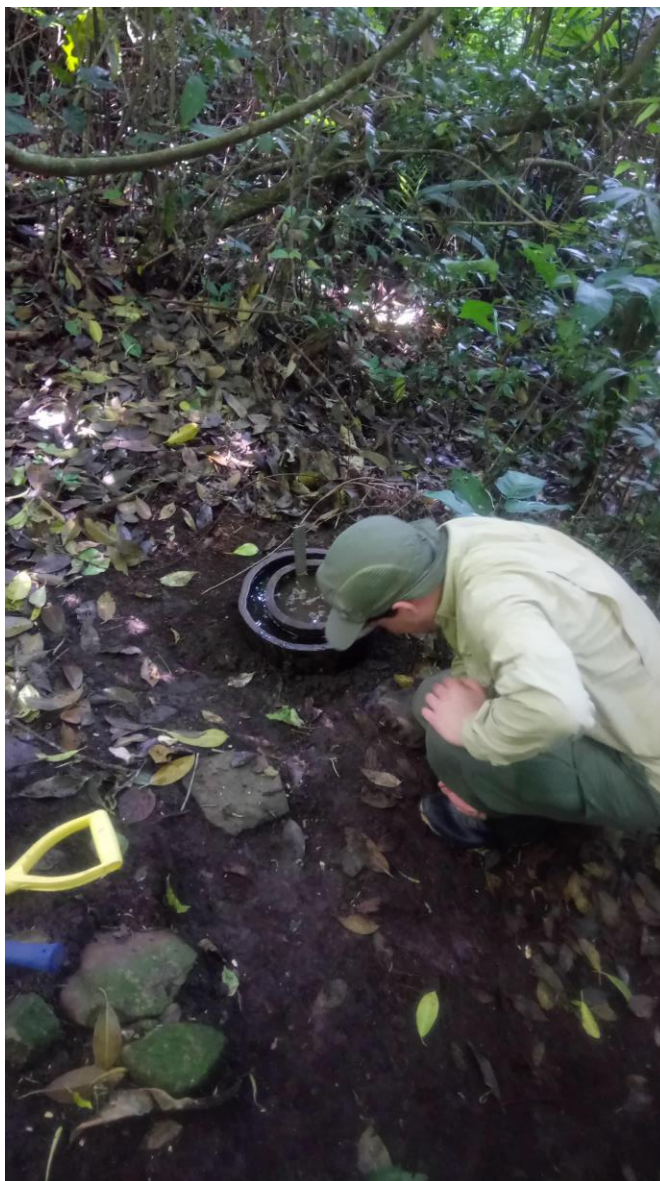
Figura 10: Prueba de infiltración por el método del doble anillo y muestreo de suelos realizados en las cercanías de la captación 3.
