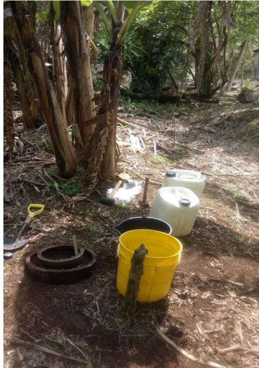
Figura 20: Prueba de infiltración por el método del doble anillo y muestreo de suelos realizados en las cercanías del Manantial Francisco Montero.
