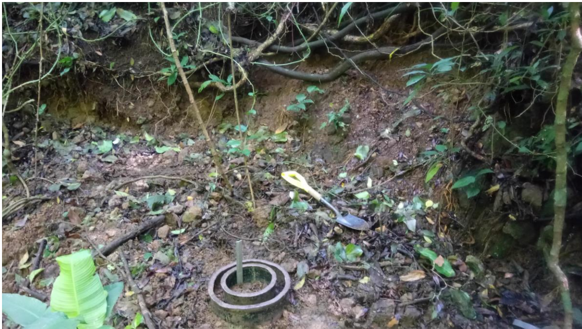
Figura 18: Prueba de infiltración por el método del doble anillo y muestreo de suelos realizados en las cercanías del Manantial Masis 2.
