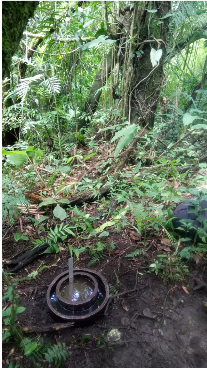
Figura 9: Prueba de infiltración por el método del doble anillo y muestreo de suelos realizados en las cercanías del Manantial Alcantarilla.
