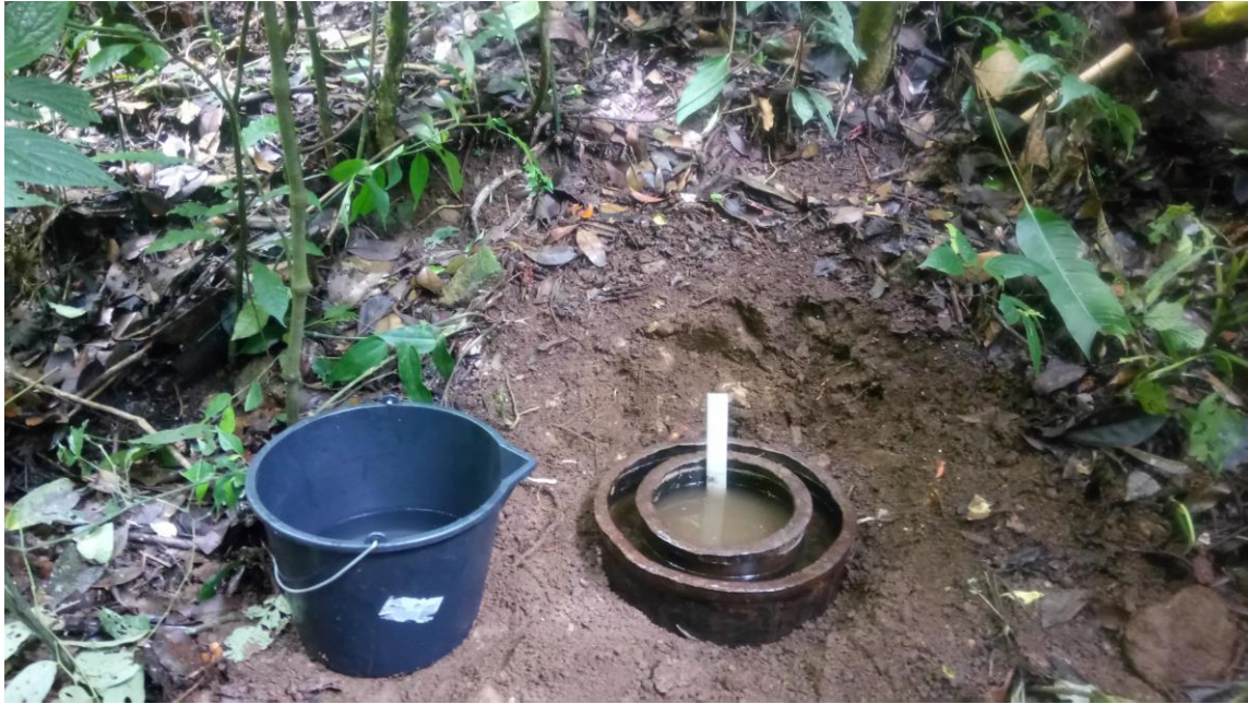
Figura 7: Prueba de infiltración por el método del doble anillo y muestreo de suelos realizados en las cercanías del Manantial Masís 1.
