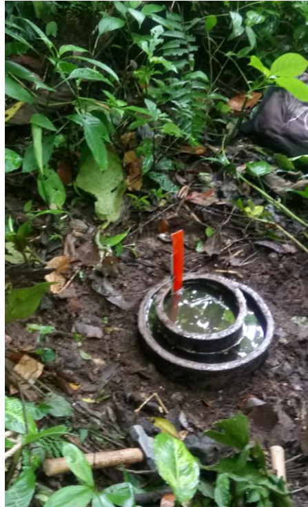
Figura 9: Prueba de infiltración por el método del doble anillo y muestreo de suelos realizados en las cercanías del Manantial La Abundancia.
