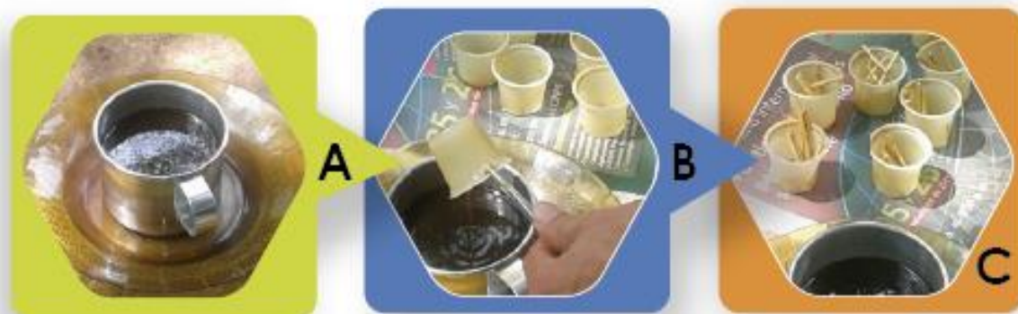
Fig. 21: Preparación de alimentadores con cera derretida.
